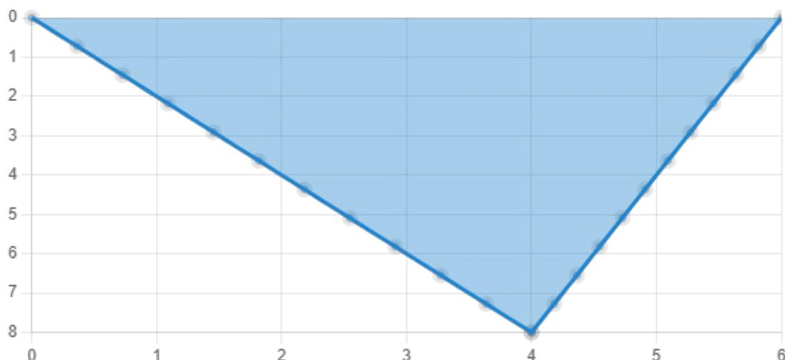
Para utilizar el método de las áreas, primero tenemos que dibujar el diagrama de esfuerzos cortantes a partir de las cargas y reacciones que tenemos en la viga.
