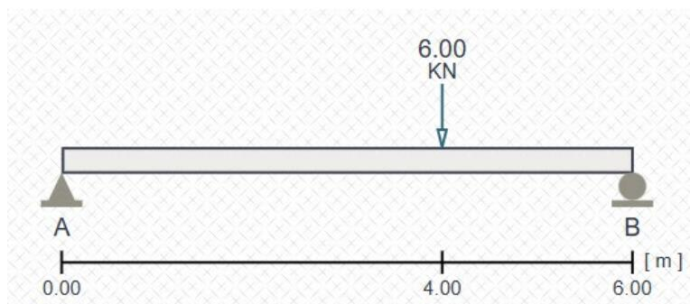
Comenzamos por calcular las reacciones en los apoyos. En el apoyo articulado hay dos grados de restricción, por lo que tenemos dos reacciones y en el móvil tenemos solo un grado de restricción, por lo que tenemos una sola reacción.
