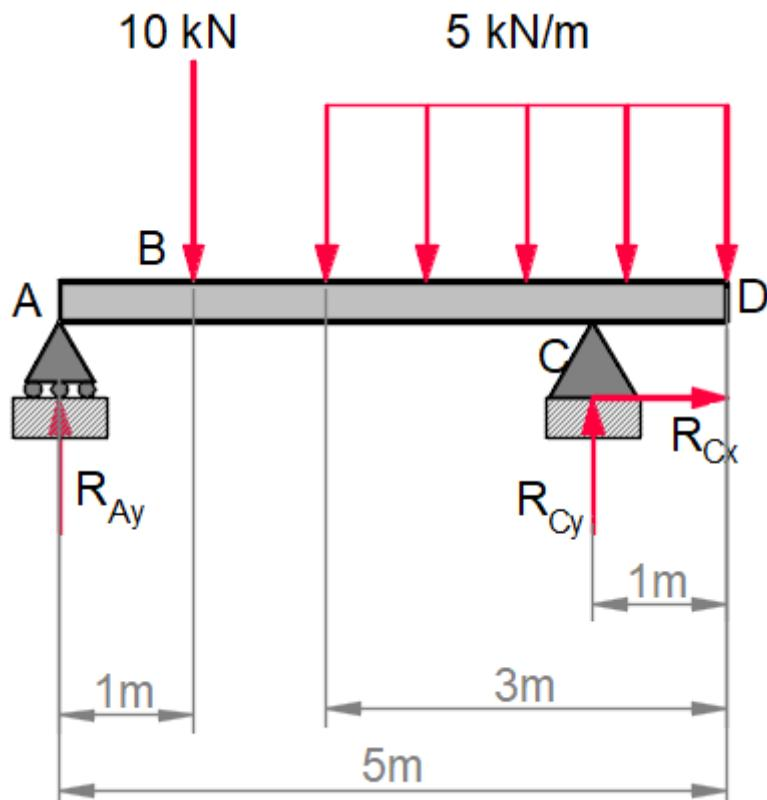
b. Para calcular las reacciones en los apoyos dibujamos el diagrama de sólido libre:
