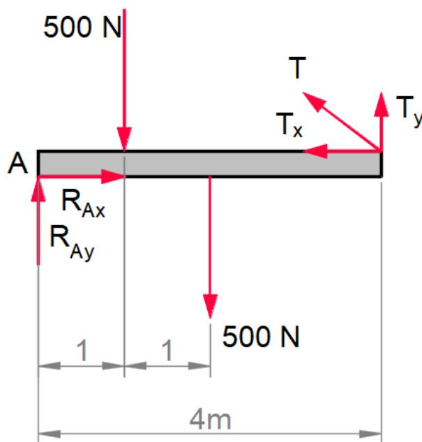
Para calcular las tensiones en el cable, aplicamos el teorema de Pitágoras:
